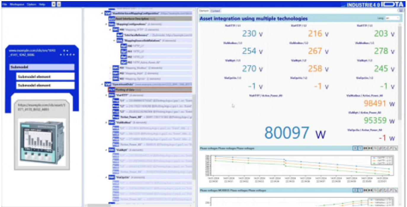
Abbildung 1: Darstellung von Laufzeitdaten im AASX Explorer durch die Nutzung der Asset Interface Description und der Asset Interface Mapping Configuration.
