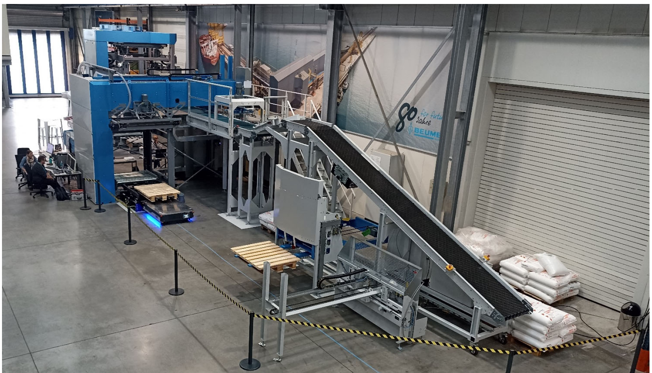
Abbildung 3: Demonstrator des MoProLog-Projekts bei BEUMER in Beckum
