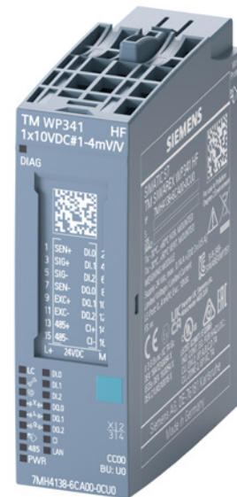
Abbildung 1: Kompakt und vollintegriert: Siwarex WP341 berechnet die wichtigsten Prozesswerte wie Förderstärke, Bandbelastung, Bandgeschwindigkeit sowie sechs Summenzähler und gibt diese an die angeschlossene Steuerung weiter.
